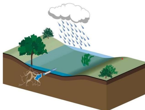
Noue à évacuation superficielle. Le sol est très peu perméable. Les eaux stockées sont évacuées à débit régulé vers un exutoire via un orifice au pied de la noue. Cet orifice doit être très régulièrement entretenu pour éviter toute obstruction (Source : Architecture & Climat)
